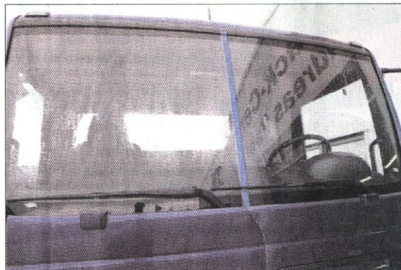
Bessere Sicht dank Lotusblüten-Effekt: Die rechte Hälfte der Frontscheibe ist veredelt, auf der linken unbehandelten Hälfte bleibt das Regenwasser haften.
